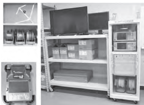
図2 地上デジタル放送技術実習システム (左上：空中線、光ファイバ、左下：接続装置)
