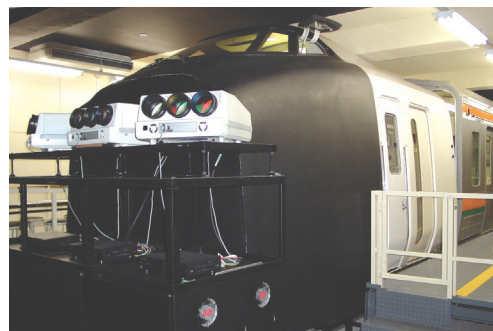
実車を用いた列車運転シュミレーター
