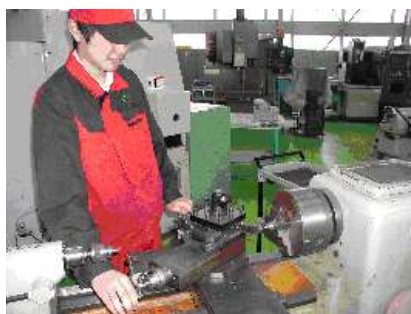
←車輪のハブを旋盤で 切削加工
